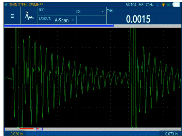
M2104(125MHz) 변환기를 사용한 72DL PLUS 측정기의 얇은 강판(두께 0.0015인치 또는 0.0381mm) 측정
